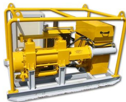
Agregat iniekcyjny AIE-200 z napędem elektrycznym i pompą PTI-150
